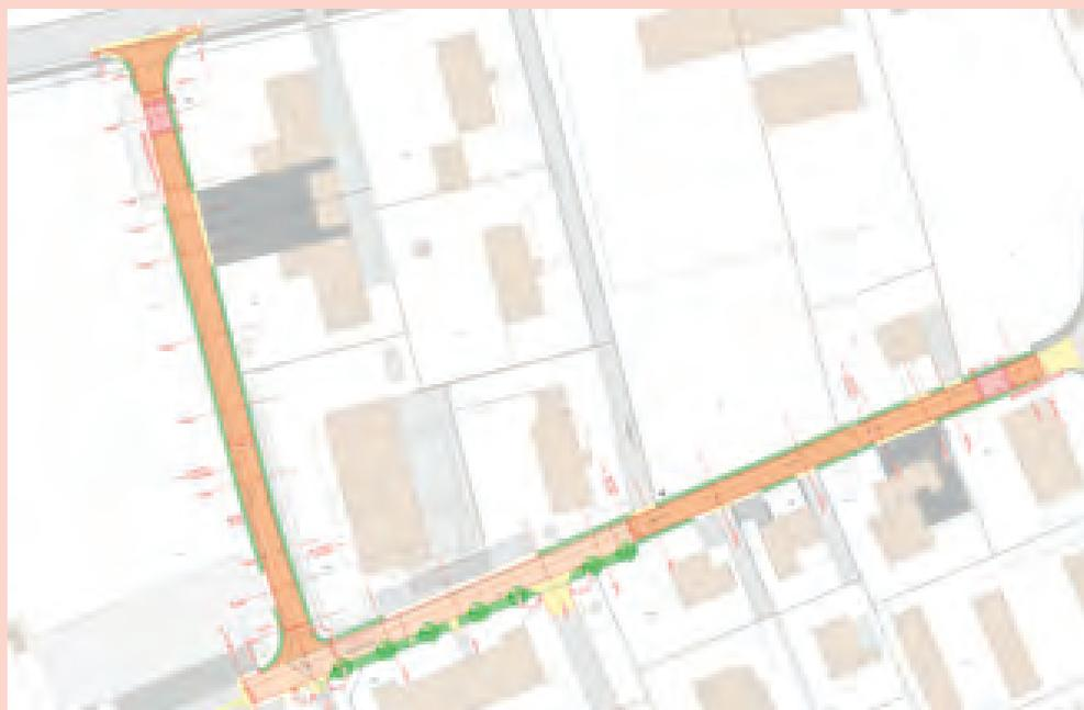
Der Sportplatzweg verfügt über keine einheitliche Strassenbreite und ragt teilweise in private Grundstücken hinein. Auch entlang des Sportplatzwegs hat es keine durchgehenden Strassenabschlüsse. Das Gleiche gilt für die Strassenentwässerung. Dagegen ist eine Strassenbeleuchtung vorhanden.
